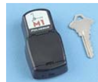
位置計測を行う LATUS ワイヤレスマーカー部 (バッテリー内蔵)
