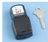
位置計測を行う LATUS ワイヤレスマーカ部 (バッテリー内蔵)
